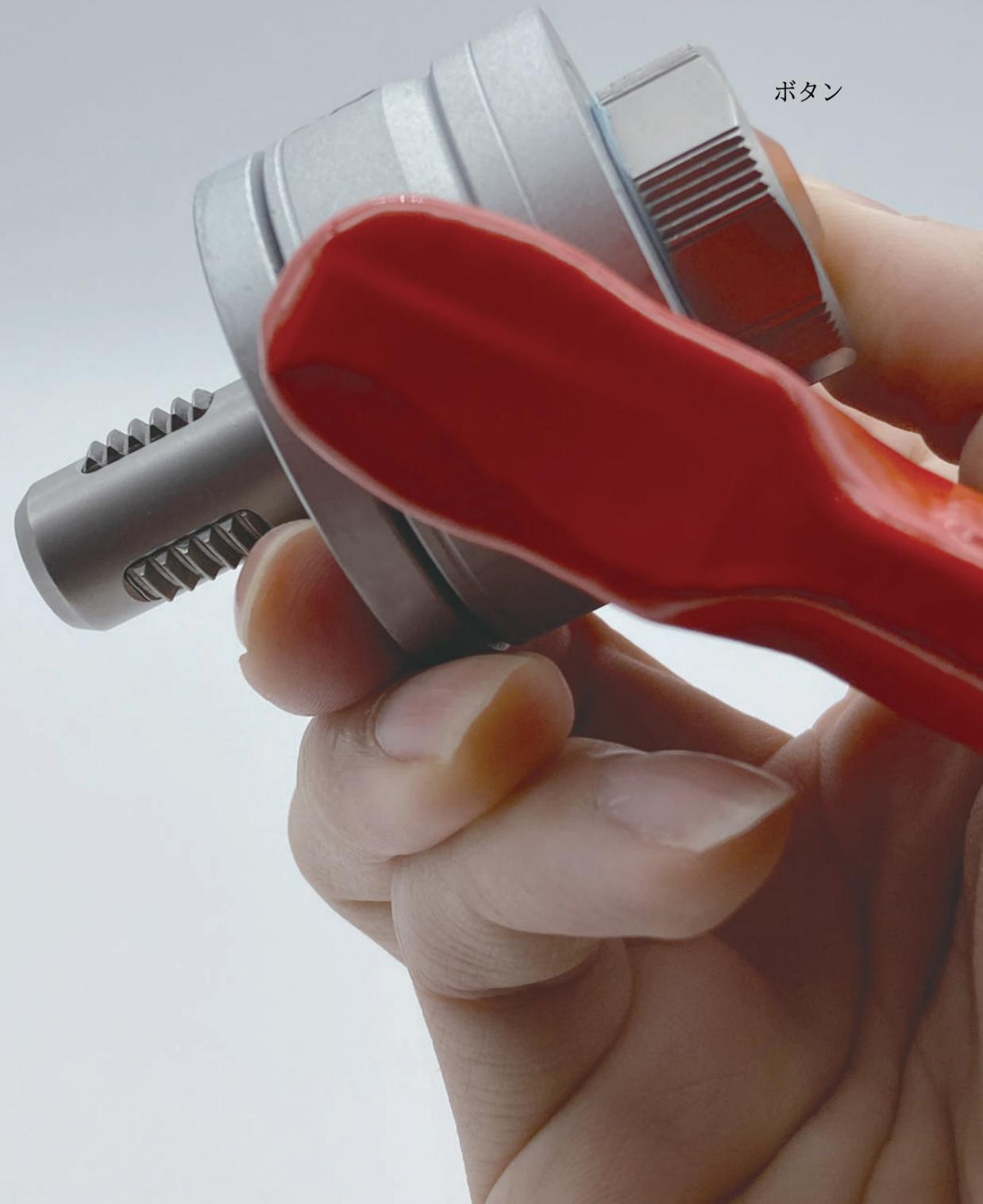
クイックリフトリングも他のコディプロ製品と同様、使用荷重の1.5倍の荷重で2万回の使用試験を行っています。また安全率は5倍で安全にご使用いただけます。
